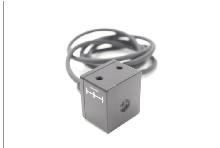
□ 다중온도센서(IR Thermopile Sensor) 기본 구성
