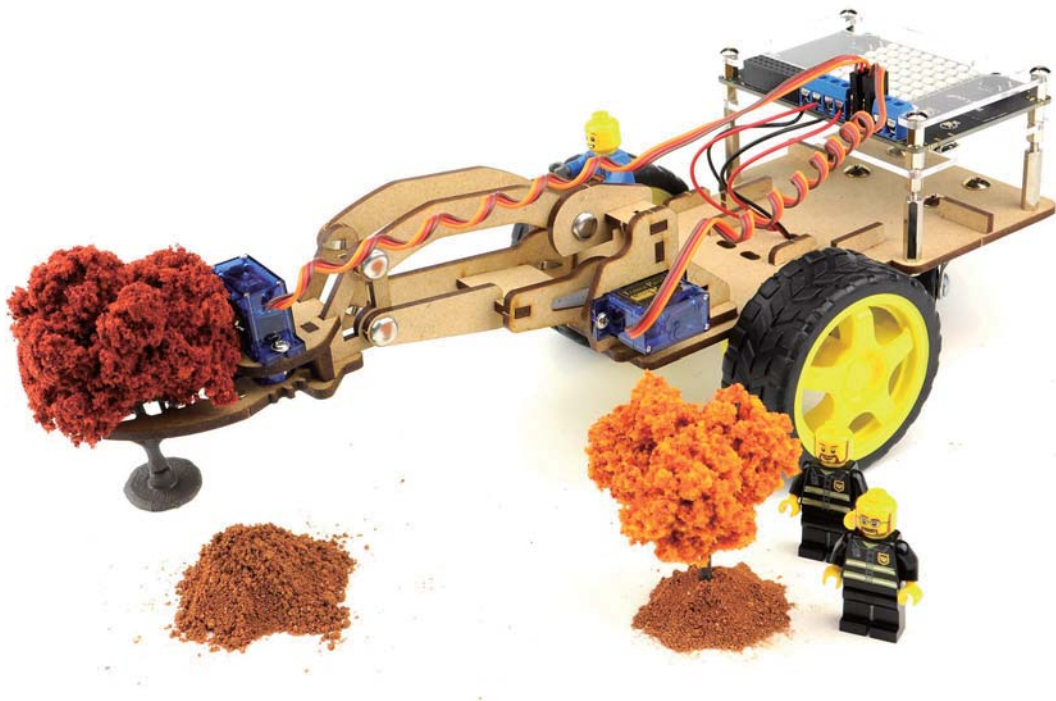
〈DC모터와 서보모터를 사용하여 집게 크레인카를 코딩한 예시〉
