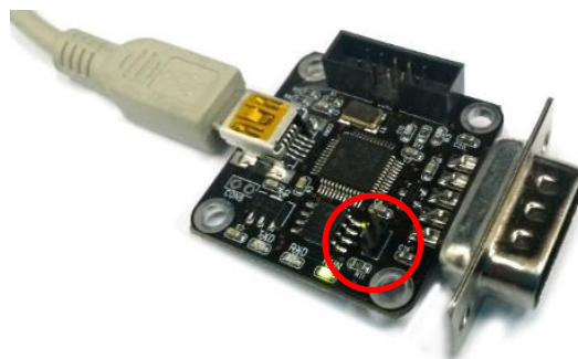
그림 1-7 USB2CAN 컨버터의 120Ω 점퍼
