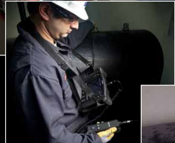
항공기 엔진의 균열, 마모 및 이물질 검사, 오일 탱크의 부식 검사, 공기 덕트의 막힘 검사
