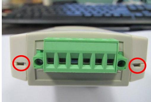
그림 8. WS-2S1E 모듈 덮개 열기
