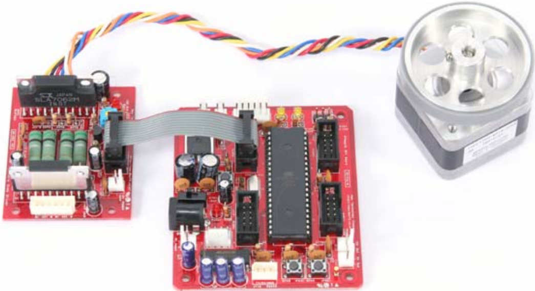
AM-M16-B와 스텝핑 모터 구동보드를 연결하여 제어하는 사진
