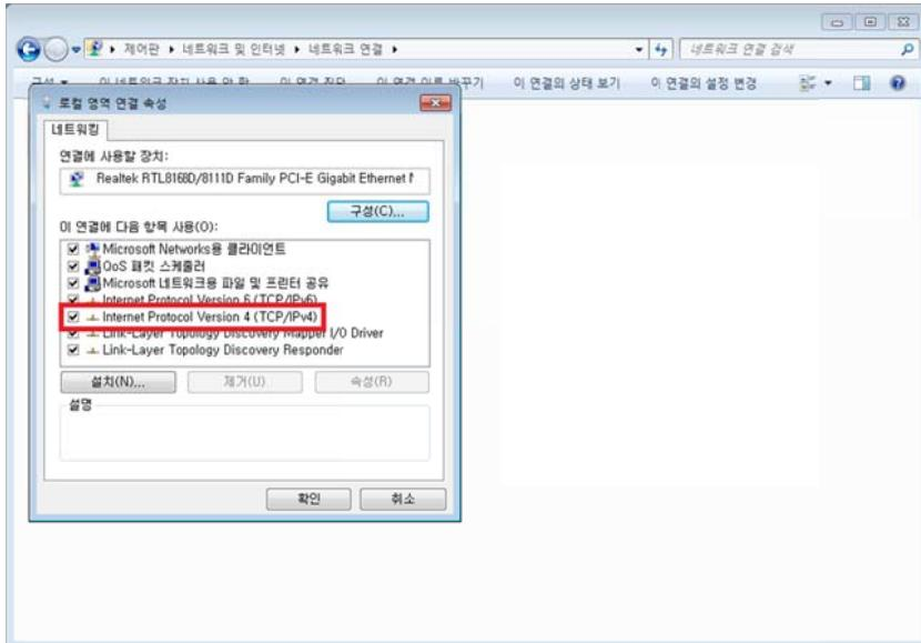
v. 다음 IP 주소 사용 체크 후 IP주소 1.0.0.2, 서브넷 마스크 255.0.0.0으로 설정 후 확인을 클릭 합니다. DS1100의 설정이 끝난 후 다시 자동으로 IP 주소 받기로 설정해 주십시오.
