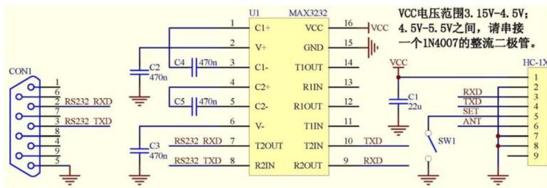
“SET”脚通过开关 SW1 接地可以进入参数设置状态, 悬空则退出。
