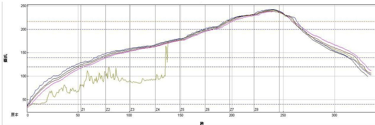
建议贴片锅炉炉温不得超过参考图温度, 二次贴片降低 5 度左右, 夏天可以再适当降低温度
