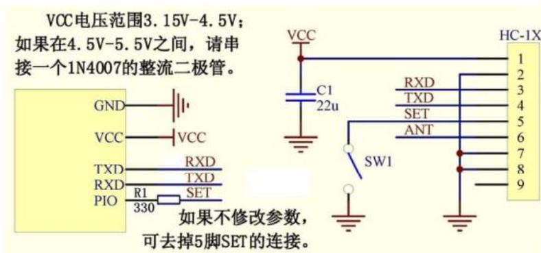
MCU中“SET”控制脚平时请置高阻状态或高电平输出, 进行参数设置时请置低电平。
