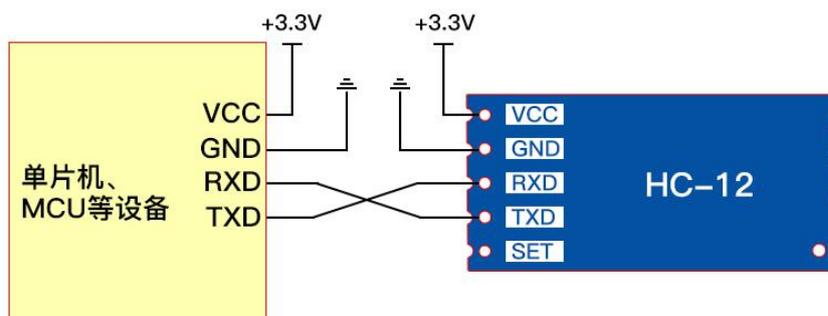
模块可与供电系统为 3.3V 或者 5V 的 MCU 连接, 串口交叉连接即可 (模块的 RX 接 MCU 的 TX、模块的 TX 接 MCU 的 RX)
