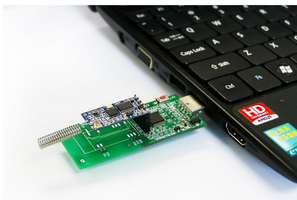
将无线模块 HC-12 放入参数架 HC-USB-T 中(如图),直接插入 PC 的 USB 接口就可以对模块进行调试。
