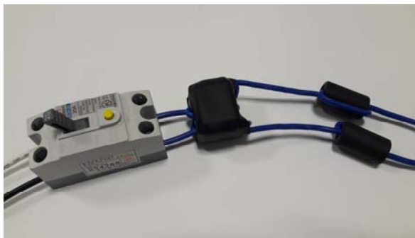
2.5/4.0 SQ 전선을 이용한 블로킹 필터 장착 사진 ( plcBlockingFilter-B 형 제품 사용)
