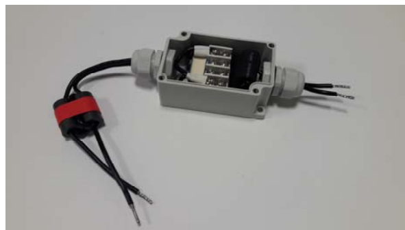
2.5/4.0 SQ 전선을 이용한 블로킹 필터 장착 사진 ( plcBlockingFilter-B 형 제품 사용)
