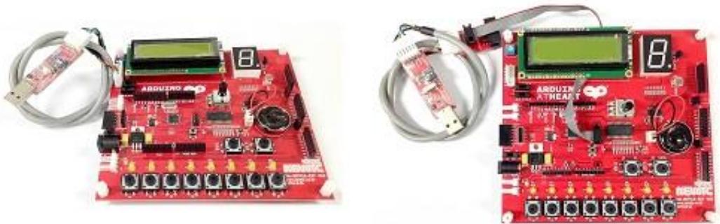
DM-USTYLE-EXT에 AD-USBISP를 연결한 사진
