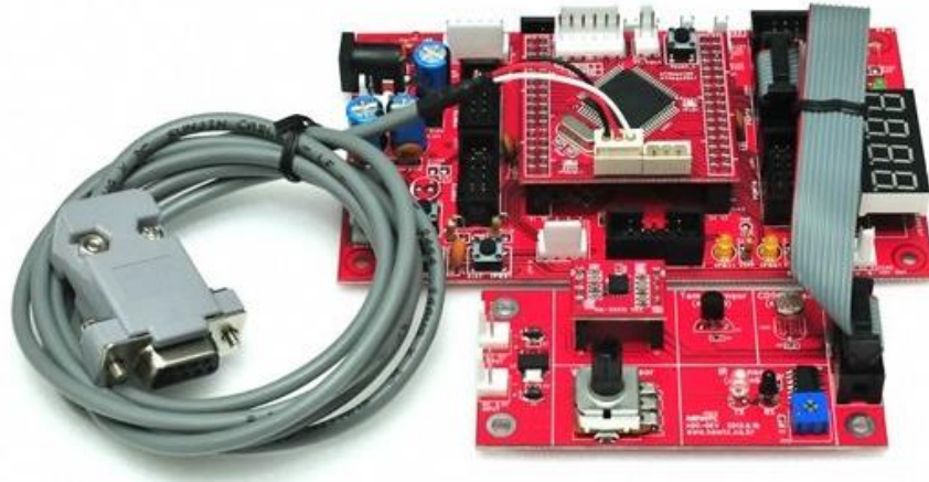
ADC-DEV 모듈을 AB-M128-PRO-A에 연결한 사진 2
