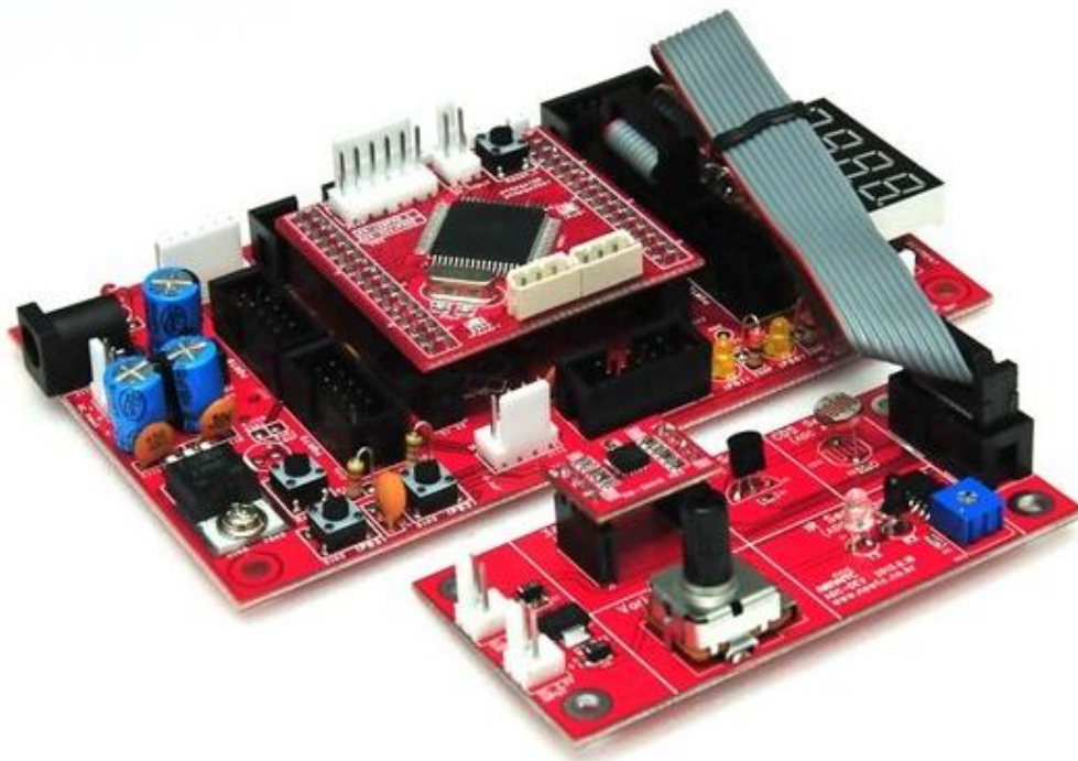
ADC-DEV 모듈을 AB-M128-PRO-A에 연결한 사진 1
