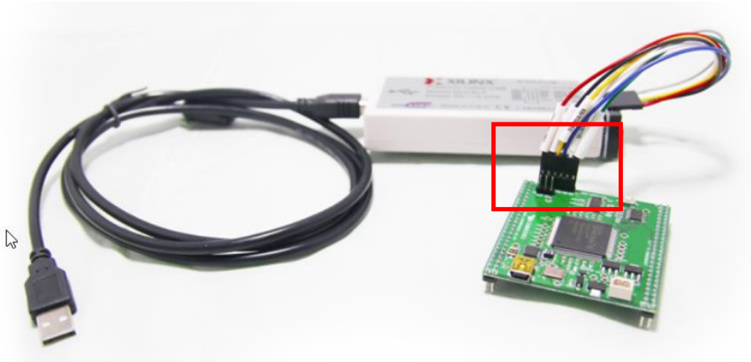
<그림 1-7> FPGA 자일링스(Xilinx) 플랫폼 케이블 USB 다운로드를 연결한 모습
