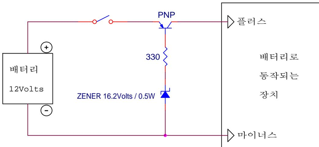
◆ 예) 3.7Volts 리튬 폴리머모 배터리로 18.5Volts ~2.1 배터리 만들기.
